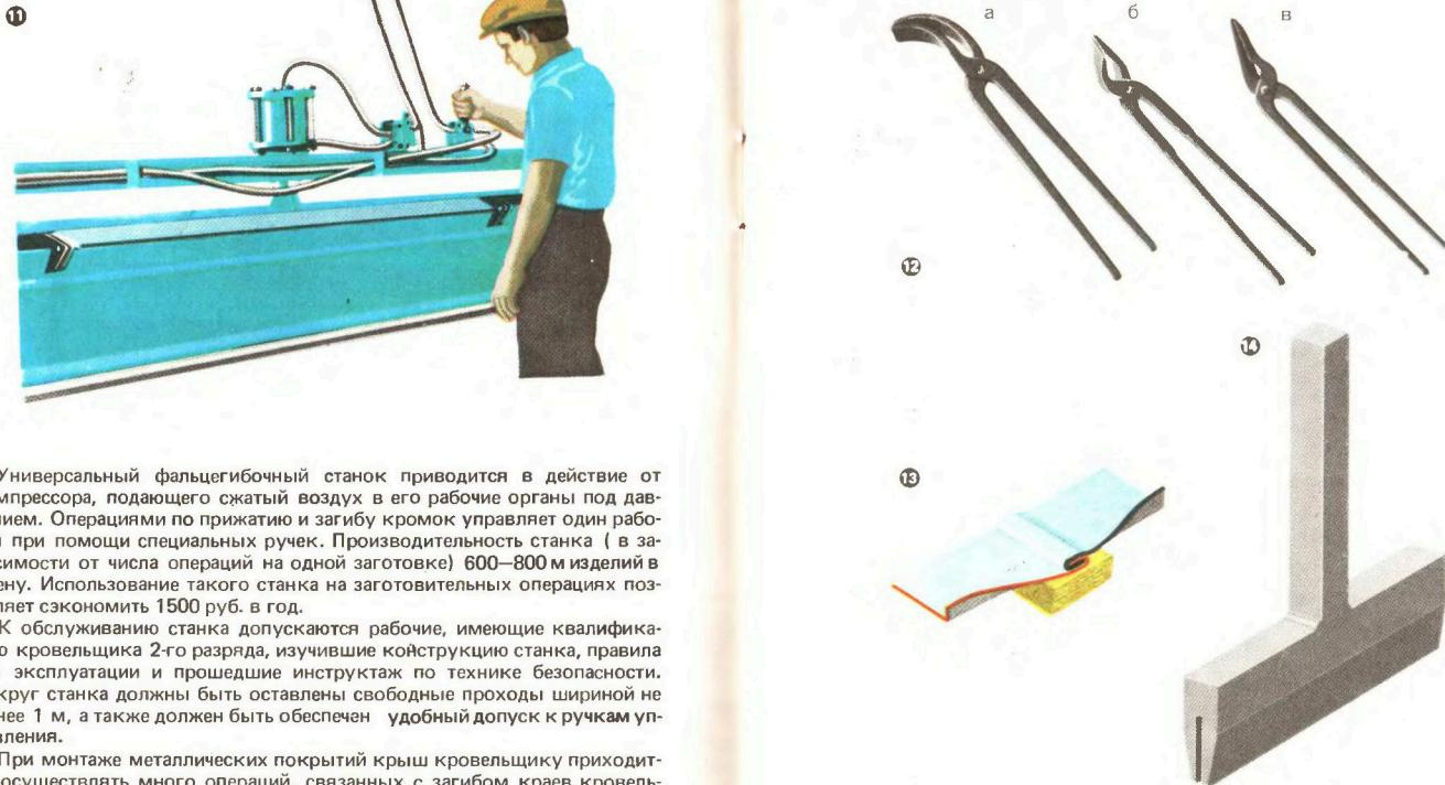
Универсальный фальцегибочный станок приводится в действие от компрессора, подающего сжатый воздух в его рабочие органы под давлением. Операциями по прижатию и загибу кромок управляет один рабочий при помощи специальных ручек. Производительность станка (в зависимости от числа операций на одной заготовке) 600–800 м изделий в смену. Использование такого станка на заготовительных операциях позволяет сэкономить 1500 руб. в год.
