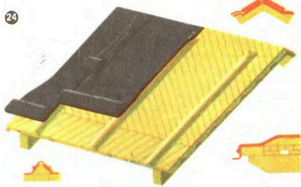
почти не реагирует на резкие суточные и сезонные колебания температур; выдерживает палиящий летний зной, солнечную радиацию и самые жестокие морозы; на нее слабо действуют выбрасываемые в атмосферу газы заводов и фабрик; рулонный материал прост в изготовлении, обладает достаточной прочностью, хорошо клеится, гвоздится и даже красится алюминиевой краской, разведенной на битумном лаке; кровля из рулонных материалов не требует большого ухода и может служить до 25 лет.
